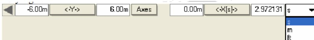
脉冲响应（IR）图像的水平坐标轴除了使用秒（s）为单位外，还可以使用米（M）和英尺（FT）两个长度单位。在把水平坐标轴的单位从时间转换为长度时，我们假定声速是固定的340米/秒。但要注意由于环境条件的不同，在实际测量中，软件显示的距离和实际的距离值之间可能可能有轻微的偏差。
