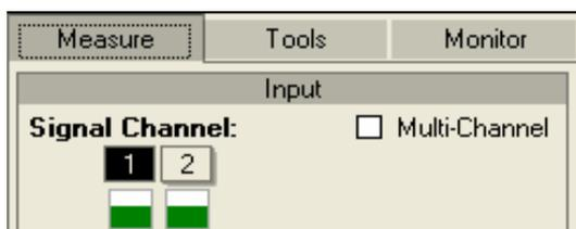
在左侧控制面板上标有“Signal Channel”（信号通道）的位置下面，有一排按钮，其中深色的按键表示该通道为当前输入通道。这些按钮上的数字，对应的是声卡上相关的输入通道号。根据你所采用的声卡的不同，这里最多能显示8个输入通道。由于输入通道的最小数值总是2，所以这里至少有2个按钮。
