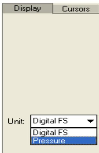
改变单位设置后，TIME SIGNAL(时间信号)图像的纵坐标单位立刻变成了 Pa 或 mPa。
