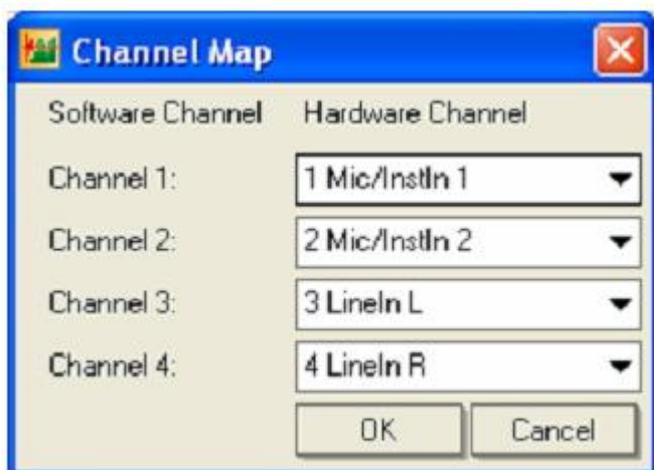
由于 SysTune 一般只允许访问一个声卡的前八个输入通道，使用这个功能，可以将某些通道数量更多（超出 8 路）的声卡的后面一些通道，映射到软件的八个“端口”上来。
