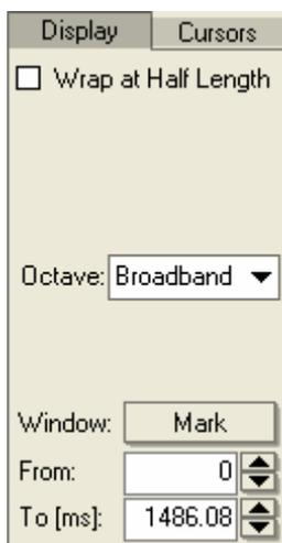
DISPLAY面板中的第一个选项，WRAP AT HALF LENGTH，勾选它可以将时间轴的0时刻位置放在图像的水平中央。后面我们会看到，这个功能在给脉冲响应图像增加窗函数处理的时候非常有用。不过对于一般的房间分析来说，更常见的是把这个零时刻位置定位在图像的最左边。我们现在可以激活此复选框，则脉冲响应图的形式将变为如下所示：
