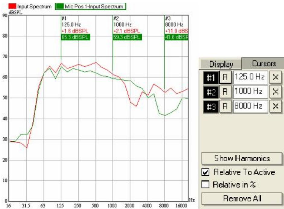
从图上可以看出，各指针上，红色曲线的绝对值被相对于绿色曲线的差值所取代。同时，作为参考值的绿色曲线的各幅度值，显示方式也从绿字变成了绿底白字。点击另一条曲线的图例标签，改变当前激活曲线，从而参考曲线也随之改变。
