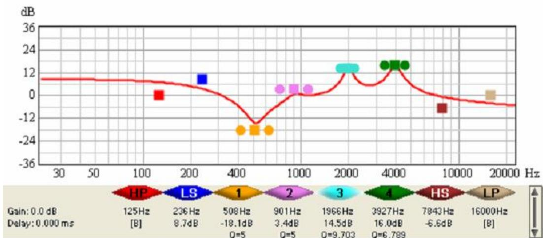
为了准确地输入滤波器参数和访问更多的功能，让我们切换到最大化模式。点击最右边的垂直按钮。结果滤波器图像部分垂直缩短，而参数区则扩大了。滤波器的参数并未发生变化，这时候你可以直接对它们进行编辑了。使用上下箭头按钮来对参数进行微调，或者直接从键盘上输入新的截止频率（FREQ），增益（GAIN）/斜率（SLOPE）或 Q 值。
