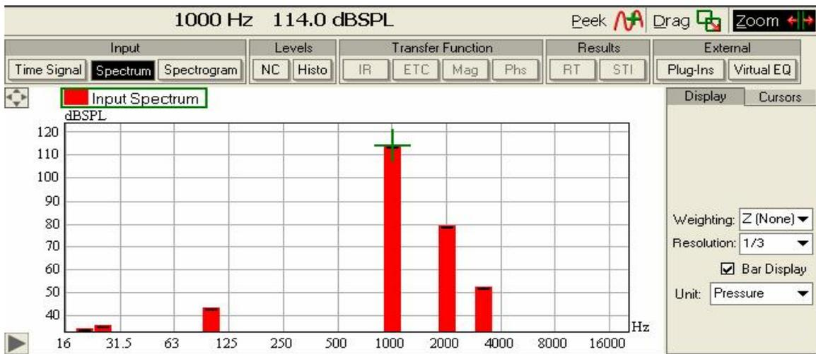
为了进一步的分析，可以暂时停止测量(点左边STOP ANALYSIS按钮)，并关掉声级校准器，将上方的TIME SIGNAL图像放大。如果你放大了图像(按下鼠标左键水平拖拽)，你将马上发现之前的粗横条其实是个压扁的正弦波信号。接着，通过鼠标跟踪十字光标，来找出该曲线的最高点，并从鼠标栏中读出数值。
